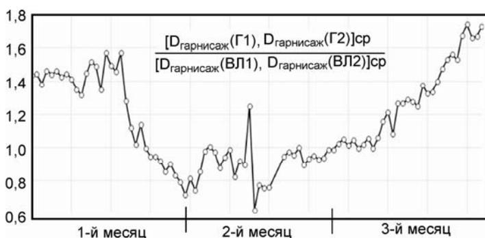
Рис. 2. Изменение отношения толщины гарнисажа горна (Г1 и Г2) к толщине гарнисажа верхней лещади (ВЛ1 и ВЛ2) в исследуемый период работы доменной печи длительностью три месяца
